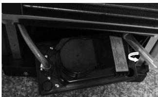
4. Remueva los tornillos (4 piezas) para remover la cobertura inferior y luego limpie la bomba de agua.
