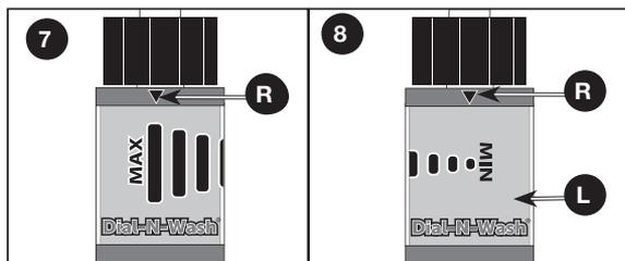
Réglez la pression en faisant tourner le régulateur Dial-N-Wash (Q) dans le sens des aiguilles d'une montre pour augmenter la pression ou dans le sens contraire pour diminuer la pression, en alignant la flèche avec la ligne indiquant la pression désirée du régulateur Dial-N-Wash.
