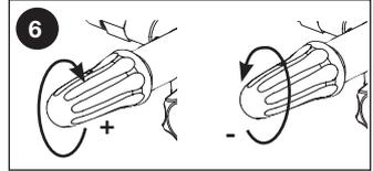
Para volver la bomba a la presión original de fábrica, gire la perilla de control de presión de la bomba en sentido horario hasta que se detenga.
