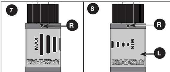
Ajuste la presión girando Dial-N-Wash (Q) en sentido horario para subir la presión o en sentido antihorario para bajar la presión, alineando la flecha con la barra de presión deseada en Dial-N-Wash.
