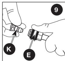
**⚠ ADVERTENCIA: Los objetos despedidos podrían causar lesiones graves. Asegúrese de que la boquilla esté completamente insertada en el adaptador de conexión rápida y que el anillo a presión de conexión rápida esté totalmente trabado (hacia adelante) antes de oprimir el disparador de la pistola.**
