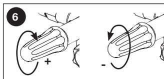
Pour retourner la pression vers la pression de réglage de l'usine, tournez le bouton de contrôle de pression sur la pompe dans le sens horaire jusqu'à ce qu'il s'arrête.
