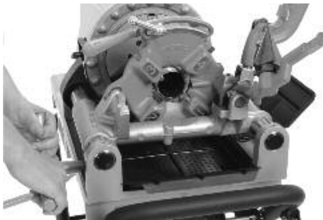
Figura 24 – Roscado de un tubo (se muestra un cabezal de terrajas de apertura rápida, Modelo 811-A)
