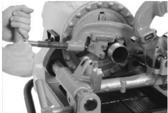
Figura 22 – Corte de un tubo con el cortador
