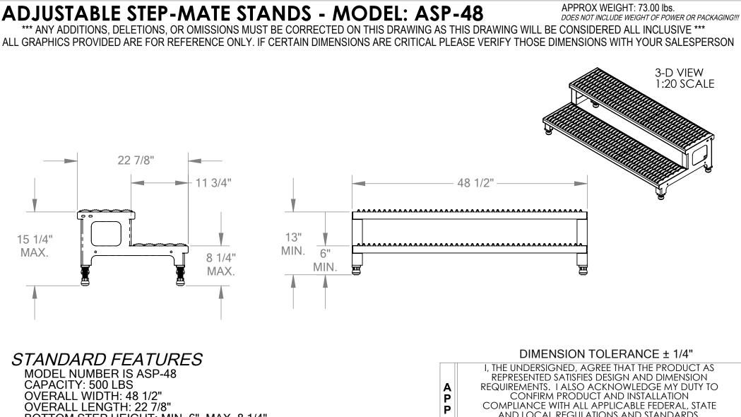
BOTTOM STEP HEIGHT: MIN. 6", MAX. 8 1/4" TOP STEP HEIGHT: MIN. 13", MAX. 15 1/4"
