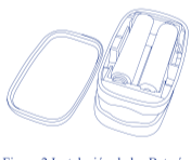
Figura 2 Instalación de las Baterías
