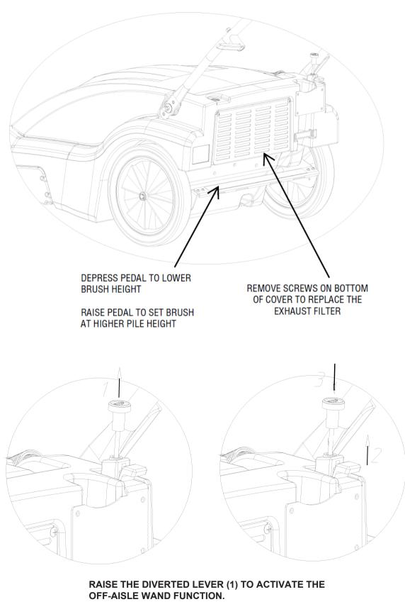
TO RELEASE THE LEVER, PULL UP ON THE LOCK TAB (2) AND PUSH DOWN ON THE DIVERTED LEVER (3) SIMULTANEOUSLY.
